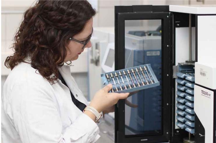
*Fatima Körfer, stellvertretende Laborleiterin für Chemische Analytik bei der OMPG, bestimmt während einer Prüfung nach VDA 278 die verdampften Substanzen mittels Gaschromatografie in Kombination mit einem Massenspektrometer. (Foto: OMPG / Steffen Beikirch)*
