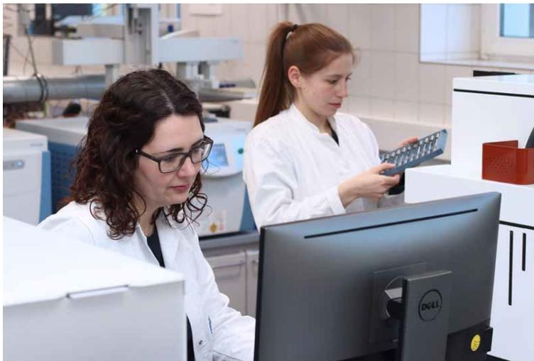
*Fatima Körfer (links) und Marie Thiel von der Chemischen Analytik der OMPG bestimmen während einer Prüfung nach VDA 278 die verdampften Substanzen mittels Gaschromatografie in Kombination mit einem Massenspektrometer. (Foto: OMPG / Steffen Beikirch)*
