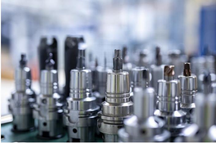
Bild 5: Die Hirschvogel Komponenten GmbH entwickelt auch bei der Fertigung verwendete Werkzeuge – hier voreingestellte Bohrer – kontinuierlich weiter. Das kommt der Prozessstabilität und der Bauteilqualität zugute. © Hirschvogel Holding GmbH
