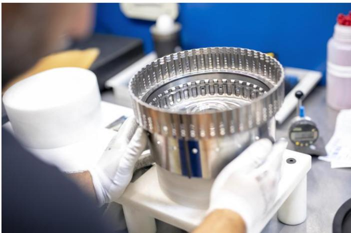
Bild 4: Hirschvogel liefert seinen Kunden bestmögliche Qualität. Letzter Bearbeitungsschritt bei komplexen Bauteilen wie dem Rotorträger ist daher die 100%-Sichtprüfung. © Hirschvogel Holding GmbH
