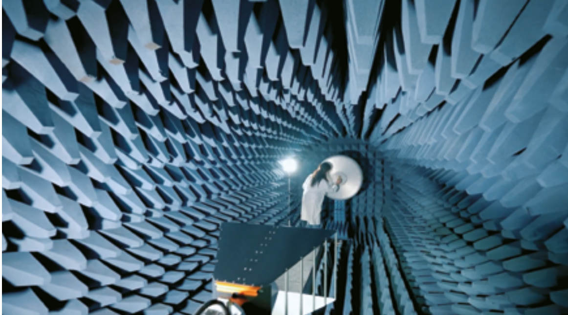
Tests in der Antennenmesskammer.
