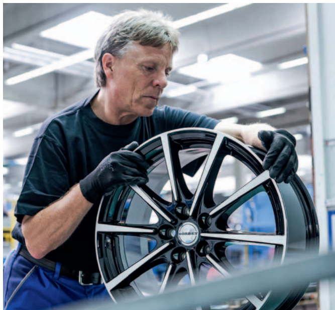
Herstellung von Felgen im Flowforming-Verfahren bei der Borbet Thüringen GmbH in Bad Langensalza, dem größten europäischen Leichtmetallräder-Werk.
