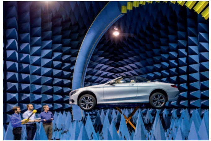
Test und Bewertung automobiler Funksysteme in der Prüfanlage „Virtuelle Straße“ (VISTA) am Thüringer Innovationszentrum Mobilität (ThIMo) der TU Ilmenau.
