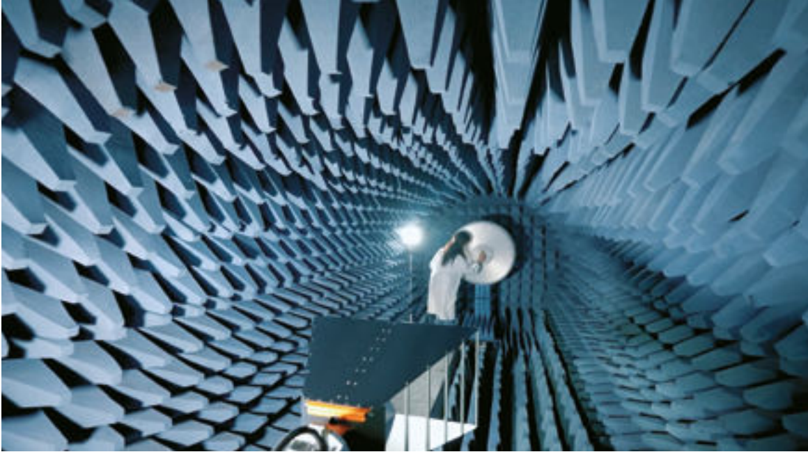
Tests in der Antennenmesskammer.
