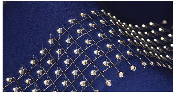
FSD-Textil: Pailletten mit elektronischen Bauelementen werden aufgestickt und mit leitfähigem Fadenmaterial verschaltet.
