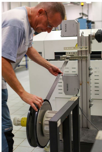
Enrico Heinlein (links) und Michael Müller im Textiltechnikum des TITK bei der Herstellung trockener UD-Tapes. (Bildrechte: TITK / Steffen Beikirch)
